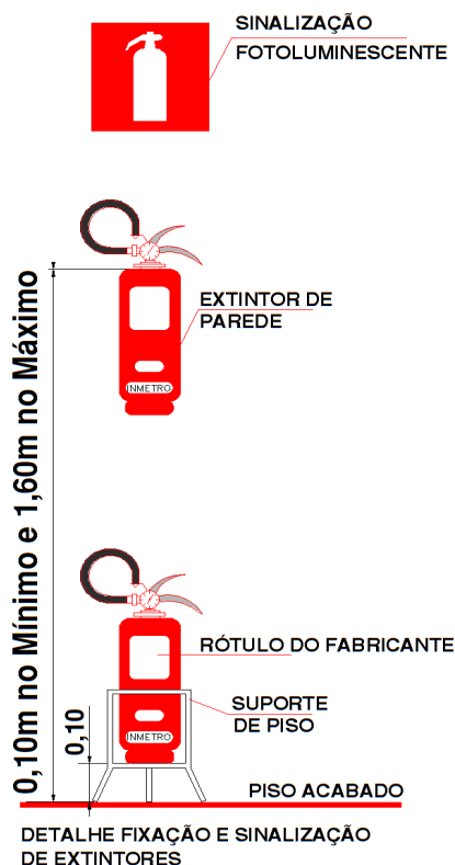
Figura 24 - Fixação de extintor. Fonte: DSCI
