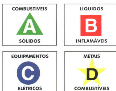
Figura 11 - Classes de incêndio Fonte: DSCI - CBPMESP
