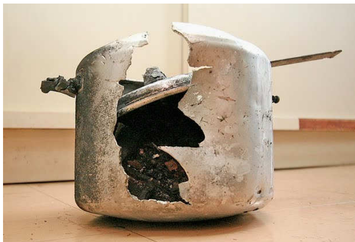
Figura 35 - Explosão em panela de pressão Fonte: DSCI - CBPMESP
