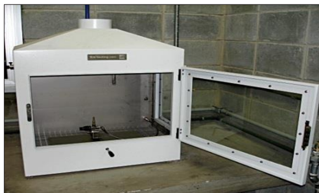
Figura 34: Determinação da ignitabilidade dos materiais
