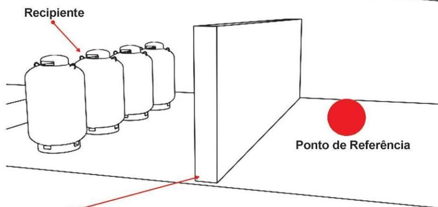
PAREDE RESISTENTE AO FOGO (TRRF 2 HORAS)
